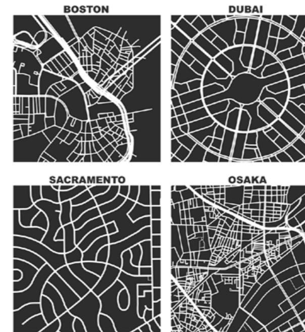
Exemples de plans de villes, «figure-ground», figure/fond qui permet de rendre très visible les axes de circulation et la structure de la ville.
